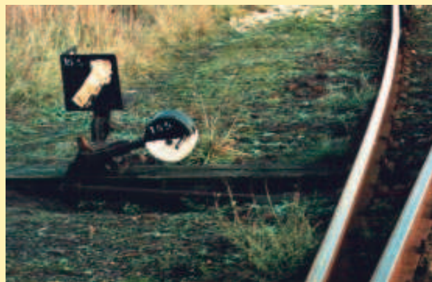
Fot. 3. Zwrotniki w prawdziwych rozjazdach: a) w postaci oświetlonej latarni, z mechanicznym napędem zwrotnicy; b) w postaci blaszanego wskaźnika z przeciwwagą do ręcznego przekładania zwrotnicy.
